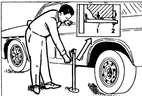
Рис. 9.17. Домкрат: 1 — лапа домкрата; 2 — проушина на днище кузова
